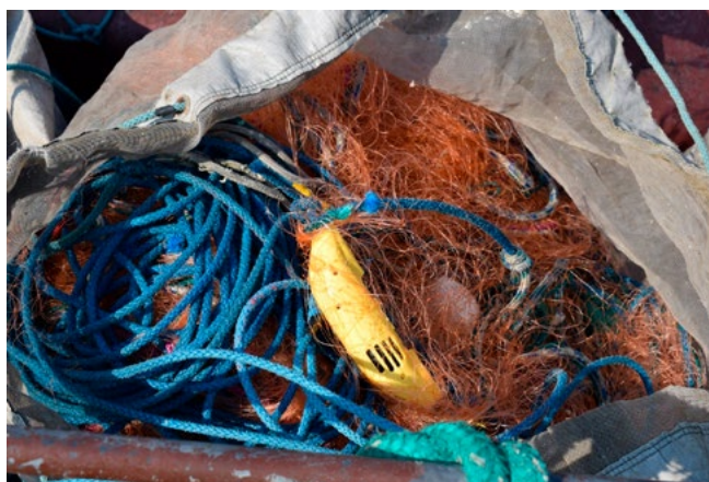
Rys. 10. Akustyczne urządzenia odstrasżające (Banana pinger firmy Fishtek Marine) zamontowane na sieciach skrzelowych (fot. W.Górski)
