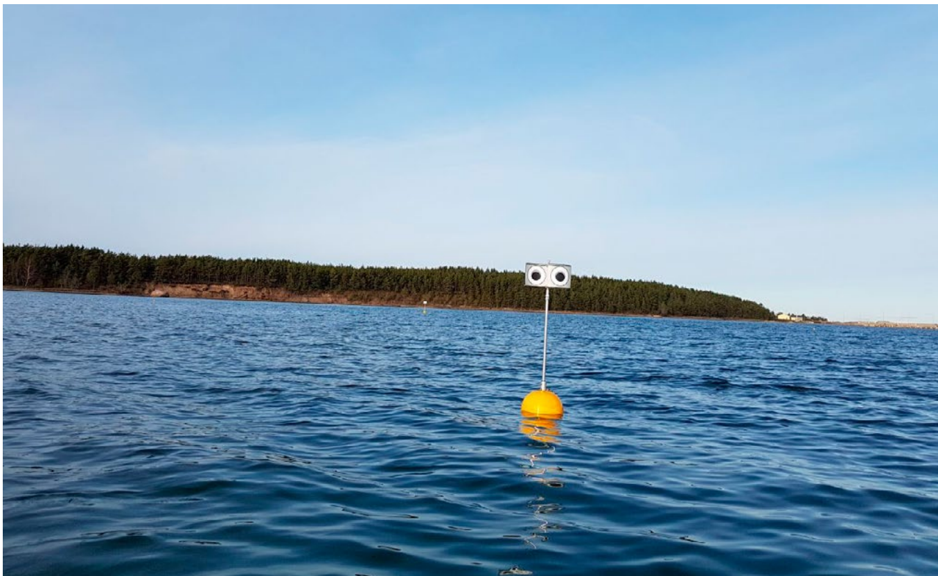
Rys. 9. Schemat i zdjęcie chorągiewki odstraszającej (fot. Fishtek Marine)
